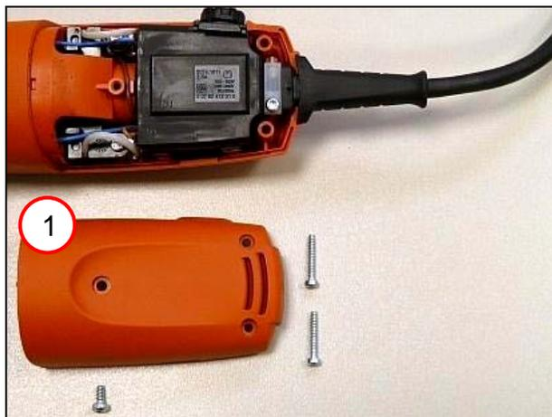
1. Instalar y atornillar la tapa (1) [1,5±0,1 Nm].
