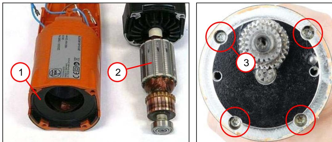
1. Instalar el anillo conductor de aire (1) en la carcasa.
