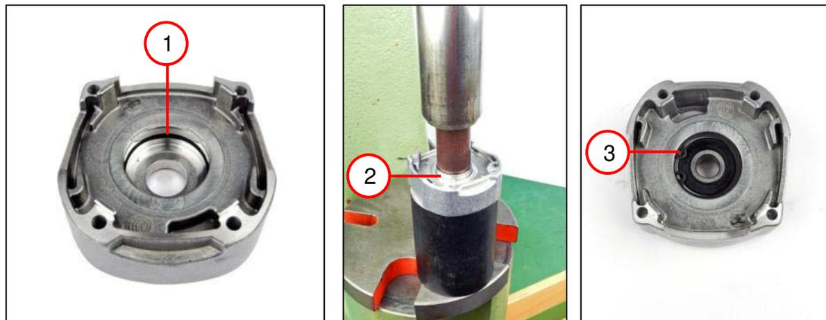
1. Enduire d'huile la bague d'étanchéité (1).
