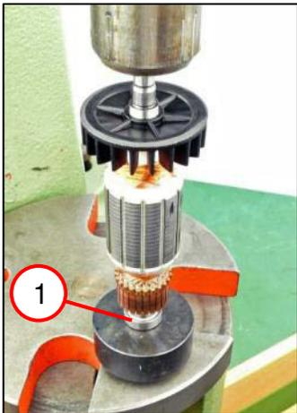
1. Das Rillenkugellager (1) auf den Anker pressen.
