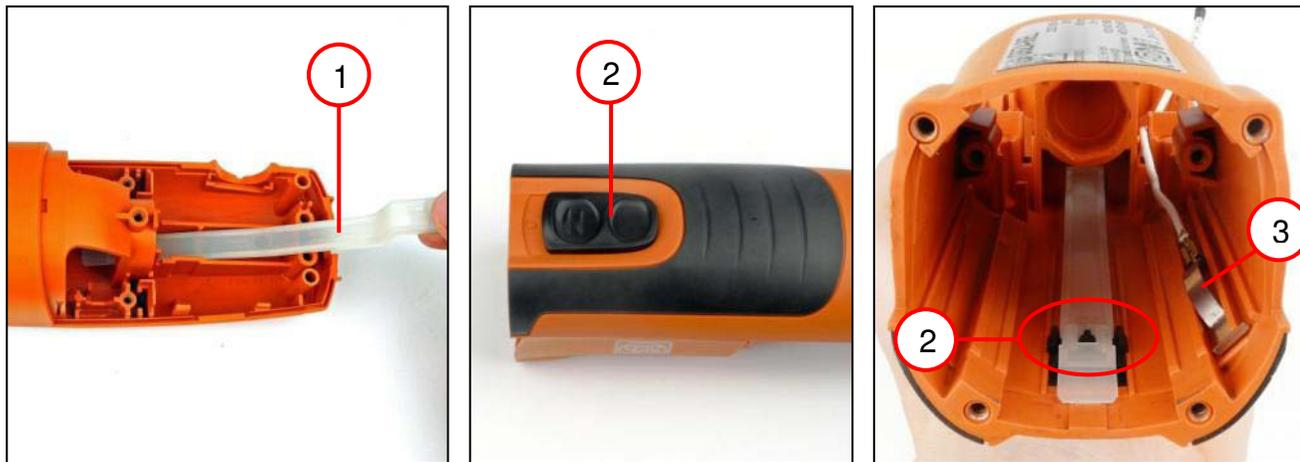
1. Die Schaltstange (1) in das Motorgehäuse schieben.
