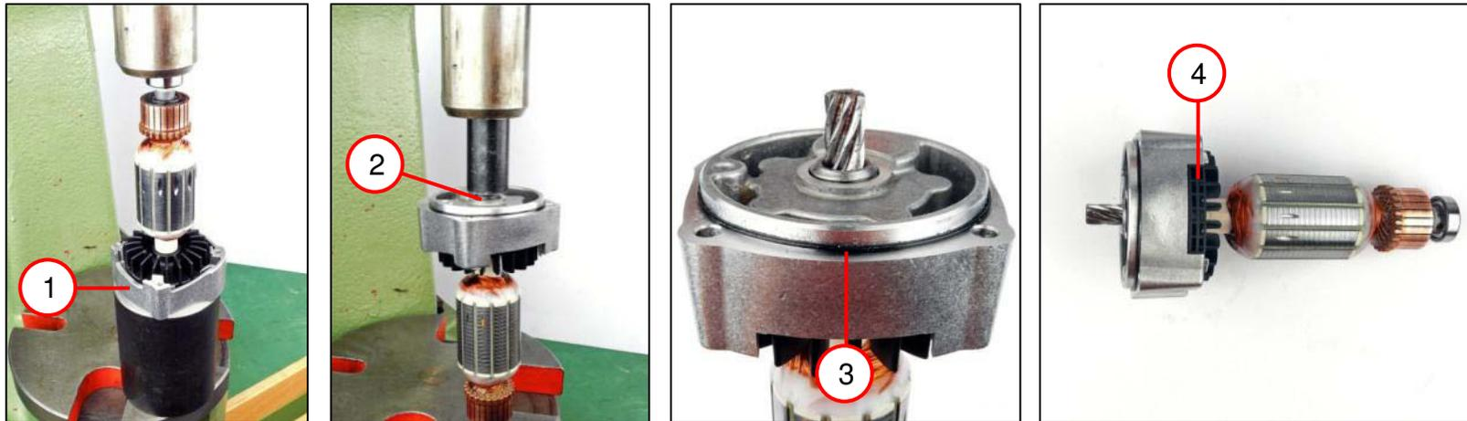
1. Den Anker in das Zwischenlager (1) einpressen.
