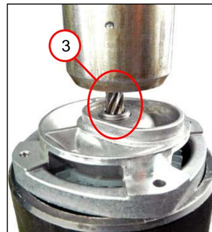
1. Снимите промежуточный подшипник вместе с якорем (1) с гребенчатого подшипника.
