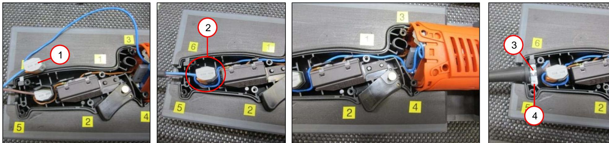
1. Подсоедините кабель электронного блока и кабель с вилкой согласно схеме соединений к клемме (1).
