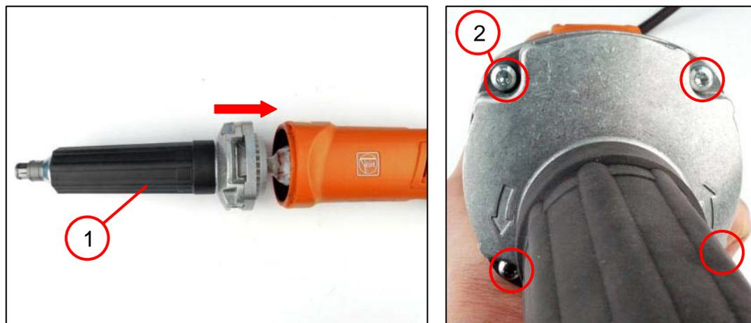
1. Вставьте гребенчатый подшипник (1) вместе с промежуточным подшипником и якорем в корпус двигателя.
