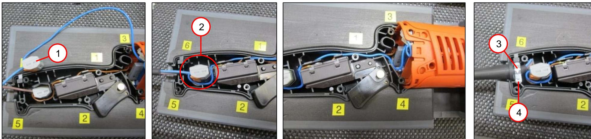
1. Connecter le câble de la platine électronique et le cordon avec fiche au bornier (1) conformément au schéma de connexion.
