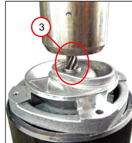
1. Das Zwischenlager mit Anker (1) vom Halslager abziehen.
